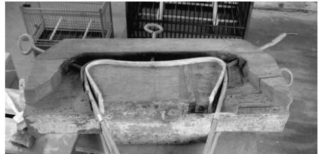
写真12 タミグーの支柱（ウフブニ）を作るための型枠。三ヶ月ほど枠に固定した状態で据え置く。適していない竹ひごを用いると、ササクレだって折れてしまう。この作業がいちばん気をつかう。
