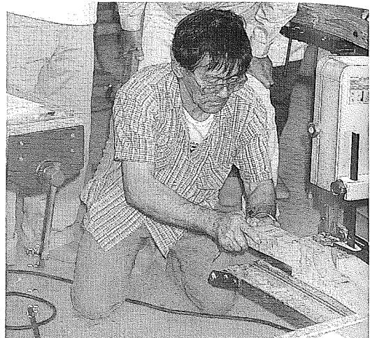
写真3 帯のこ盤での切断
