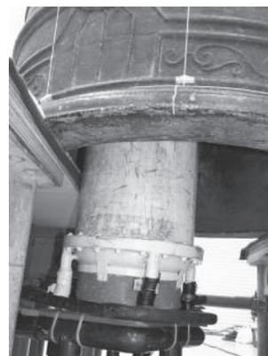
図4 内側にセットしたX線発生装置
