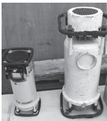
図2 使用した工業用X線検査装置
