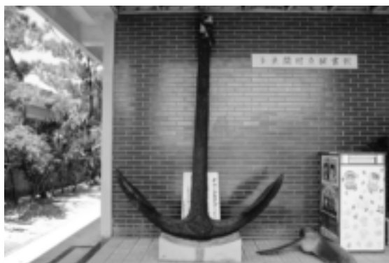
写真4 ファン・ボッセ号が装備した西欧型鉄錨(ストックが木製)
