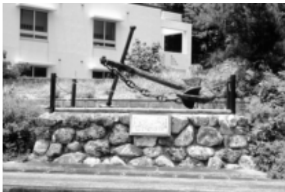
写真5 ベナレス号が装備した西欧型鉄錨(ストックの材質不明)
