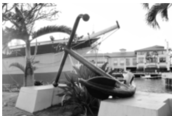
写真2 ストックが鉄製の西欧型鉄錨（ハワイホノルル港）
