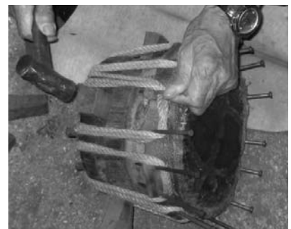
図13 木製の楔を差込み、蛇皮に張力をかける。
