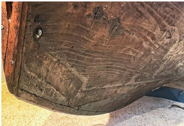
写真4-1 サバニ カーラ、継ぎ目がわかる
