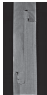
図30 同CT画像 （正面） 凸部の側にく さびの木辺が 確認できる
