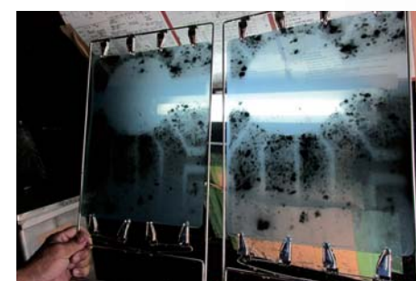
旧首里城正殿鐘のX線写真（2014年9月）
